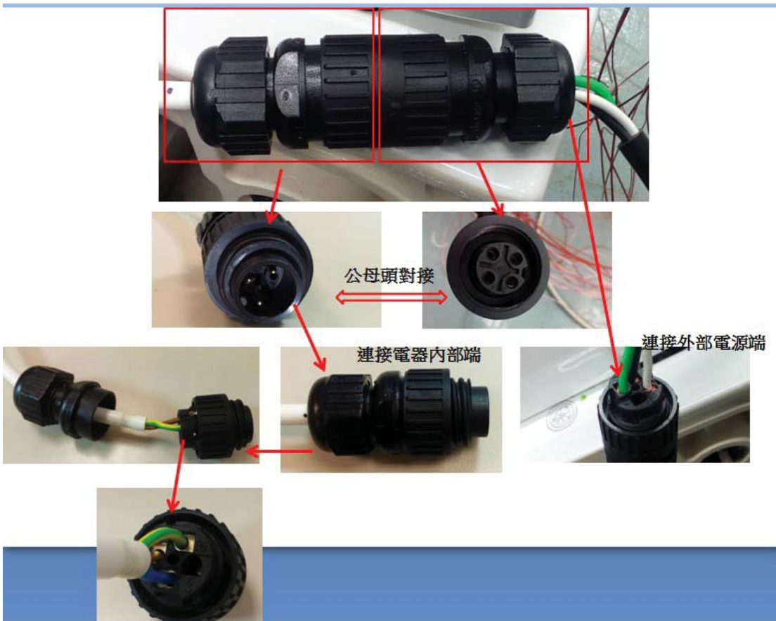
電子式馬桶（便）座商品之電源輸入使用連接器裝置連接
